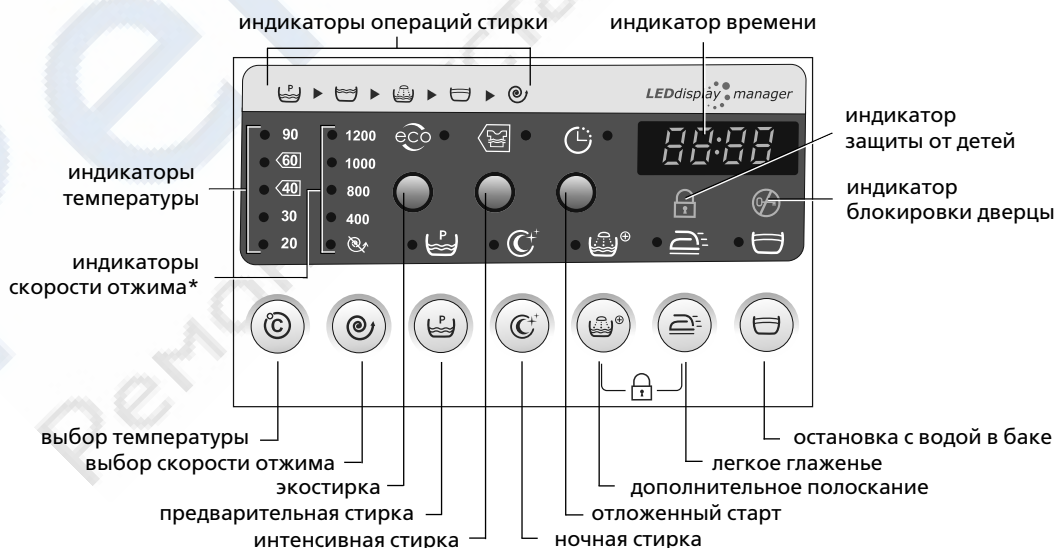
Рисунок 3 — Зоны индикации и кнопки выбора дополнительных функций
